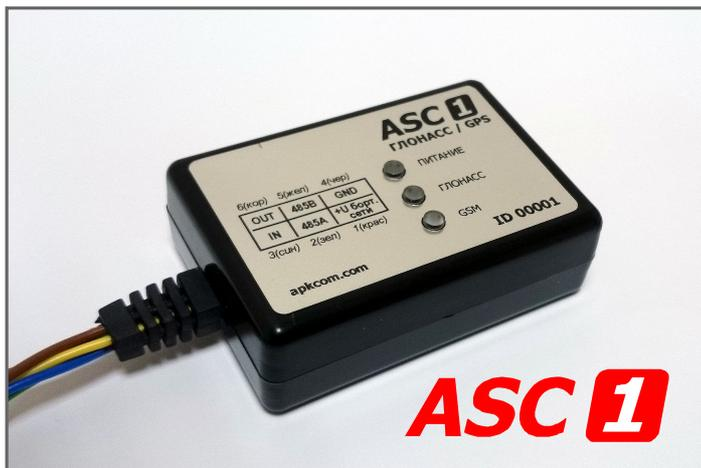
Абонентский телематический терминал спутникового мониторинга транспортных средств, стационарных и подвижных объектов.
